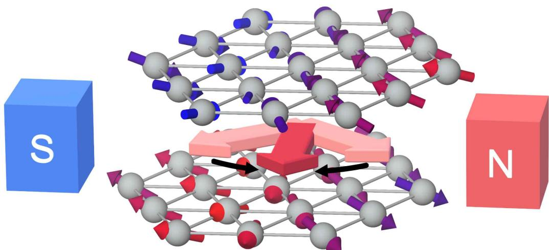
[그림 2] 이원자층  $\text{NiI}_2$ 에서의 스핀 정렬에 따른 전기 편극 형성과 자기장 인가에 의한 편극 회전에 대한 모식도.
